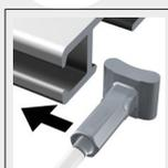
Il est possible de fixer le fil de suspension avec coulisse par le côté du rail. Artiteq a développé pour cela le système Solid Slider, disponible sur un fil en perlon ou en acier de 2 mm. Le fil de suspension glisse librement dans le rail de suspension mais ne peut être sorti en n'importe quel point du rail. Les fils de suspension avec système
